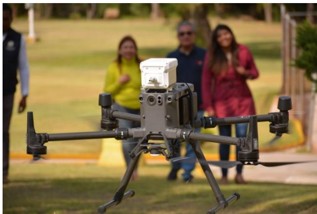
Imagen 8. Sniffer montado en dron Matrice 300
