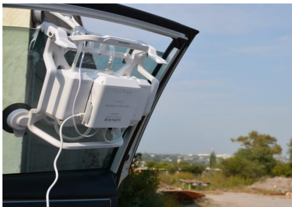
Imagen 7. Sniffer montado en vehículo
